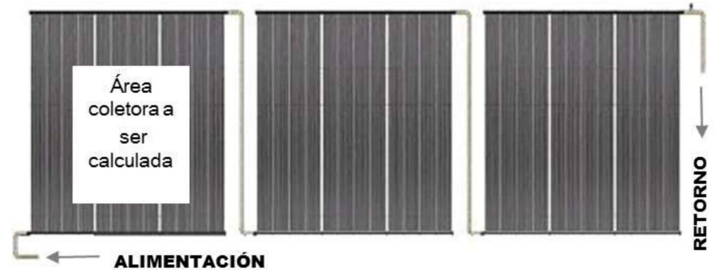
La primera batería alimentada es quien influye en el dimensionamiento de la tubería y de la bomba hidráulica.
